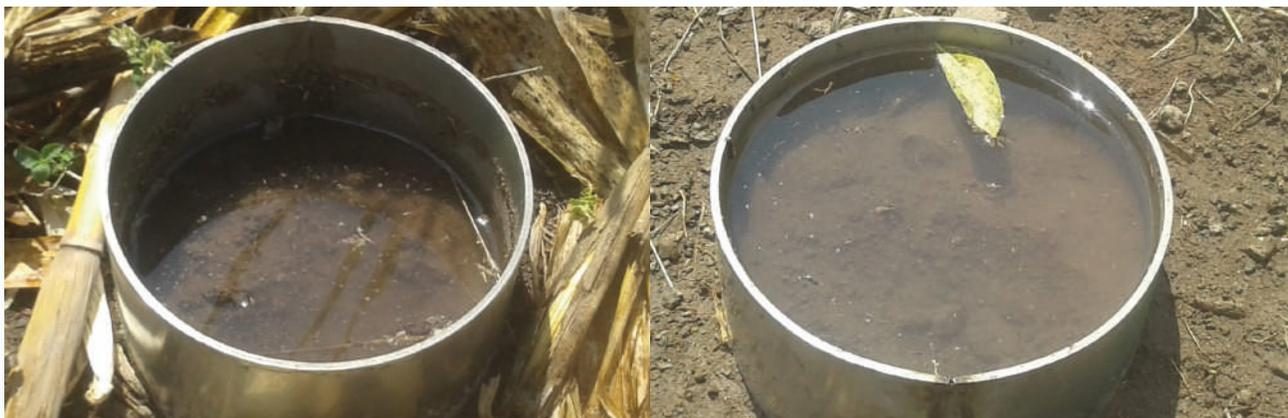
Prueba de infiltración en parcela con (izquierda) y sin (derecha) prácticas de restauración. Infiltración 10 minutos después de llenar los cilindros con 500 cc de agua.
